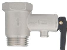
・ この種類のバルブは、給水の圧力上昇による損傷を防止するために、湯沸かし器に使用します。過度の圧力を解放することにより、システムは通常の圧力範囲で動作します。
